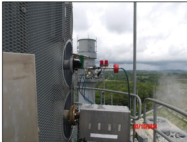
ภาพที่ 4 แสดงการตรวจวัด RM Method ของบริเวณ ปล่องหน่วยผลิตไอน้ำ HRSG# 42
