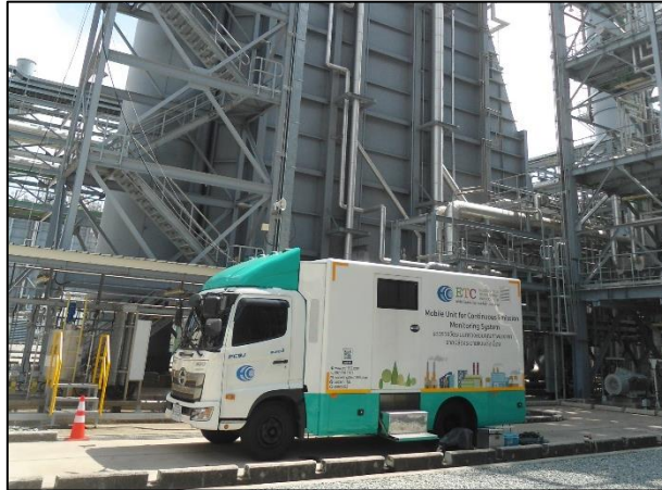
ภาพที่ 3 แสดงการตรวจวัดเพื่อทดสอบความแม่นยำสัมพัทธ์ ระบบ CEMS สำหรับตรวจวัดก๊าซ ของบริเวณ ปล่องหน่วยผลิตไอน้ำ HRSG# 42
